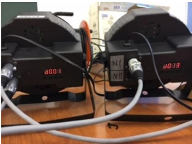
照明1はDMXコントローラーの1～7のフェーダーで、照明2はDMXコントローラーの13～19のフェーダーでコントロールします。
